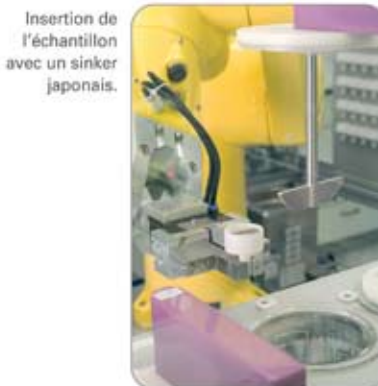
Le bras du robot réalise un changement de méthode pale-panier.
