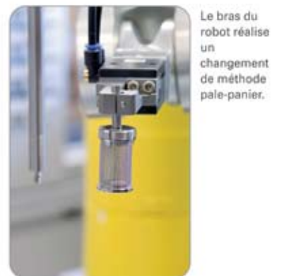
Le bras du robot réalise un changement de méthode pale-panier.
